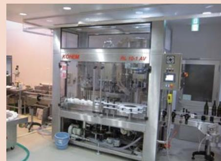
・写真は 9 ヘッド充填 + 30x60 スクリューキャップ 1 ヘッドのモノブロック機 ・ヘパフィルターを搭載
