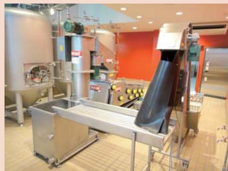
・写真はリンゴを洗浄、選果、破碎し、ベルトプレスで搾汁する一連のライン ・ヴォランはシードル機器大手
