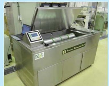
・実験用モルティング（製麦）装置 ・日本では研究所や大手モルト製造会社で利用されています
