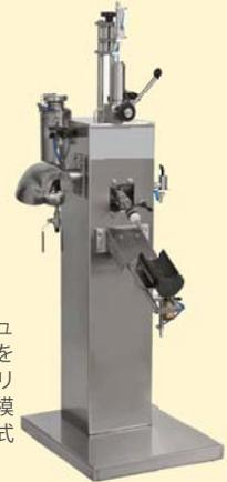
・手でデゴルジュマンとドザージュを行う装置 ・イタリアのペシェは小規模生産向けの設備一式をラインナップ
