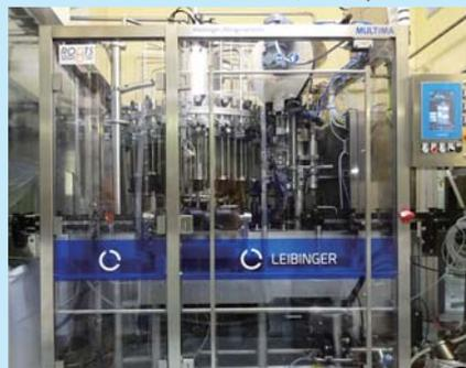
・地ビールロータリー機のベストセラー SMBを引き継ぐブランド ・写真は18ヘッド充填+4ヘッド打栓のモノブロック
